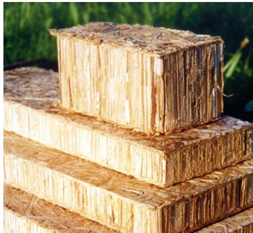
Dieses Sandwich vermag, was die Biegesteifigkeit betrifft, bei geringem Gewicht erstaunliches zu leisten und dürfte nach wie vor das Material sein mit dem günstigsten Verhältnis von Durchbiegung zu Gewicht. Es überzeugte auf den ersten Blick und war die Basis zu einer Anregung, ein Förderprojekt bei der Deutschen Bundesstiftung Umwelt zu beantragen zur Klärung der mit dem Anbau verbundenen Fragen.
