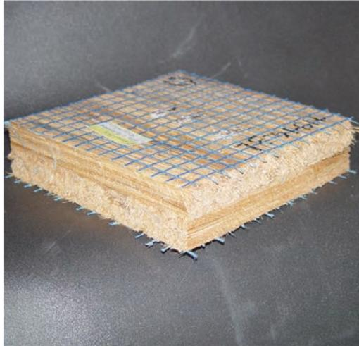
Die Erstellung eines Plattenmaterials aus zwei senkrecht zueinander stehenden Schichten mit liegender Orientierung bringt eine weitere geringe Absenkung der Wärmeleitfähigkeit (Bild 6). Allerdings steigt damit auch der Herstellungsaufwand merklich an.
