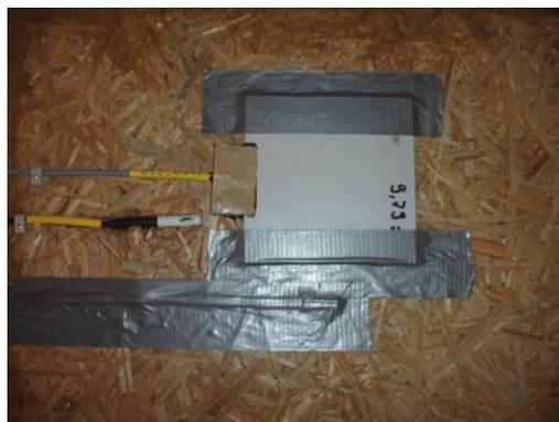
Bild 18: Temperaturfühler, Wärmefluss-scheibe sowie Feuchtefühler an der Grenzschicht 3, unterhalb der Innendämmung auf der zweiten Dämmplattenebene, Foto IBP
