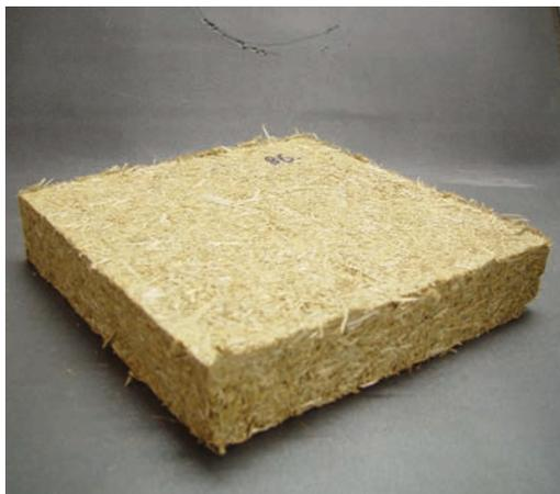
Fasert man das Blattmaterial komplett auf, erreicht man auch völlig ohne Ausrichtung ein Plattenmaterial, das nahezu die gleiche Wärmeleitfähigkeit wie das Plattenmaterial aus zwei senkrecht zueinander stehenden Schichten mit liegender Orientierung aufweist (Bild 7).
