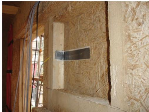
Bild 17: Temperaturfühler an der Grenzschicht 2, zwischen den beiden Dämmstoffplatten im Gefach, Foto IBP
