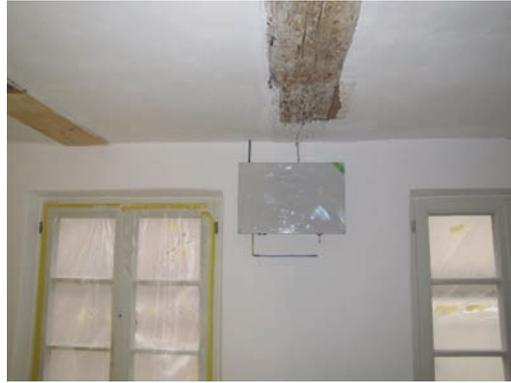
Bild 20 zeigt die Situation im Februar 2011 nach Fertigstellung der mit einem Innenputz versehenen Wand mit endgültiger Position des Gerätekastens, sowie den Oberflächentemperaturfühler und den Kombisensor für Raumlufttemperatur und -feuchte (im Unterboden des Gerätekastens).
