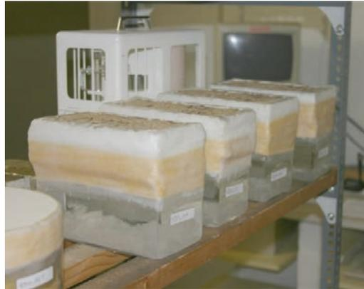
Bild 2: Auf die Prüfgefäße dicht aufgebrachte Typha-Platten während der Diffusionswiderstandsmessung, Foto IBP
